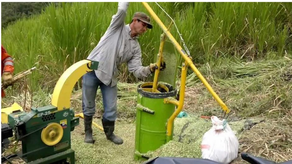
Figura 8. Compactación de silo bolsa con palanca manual. Fuente. (Practiagro, 2012)
