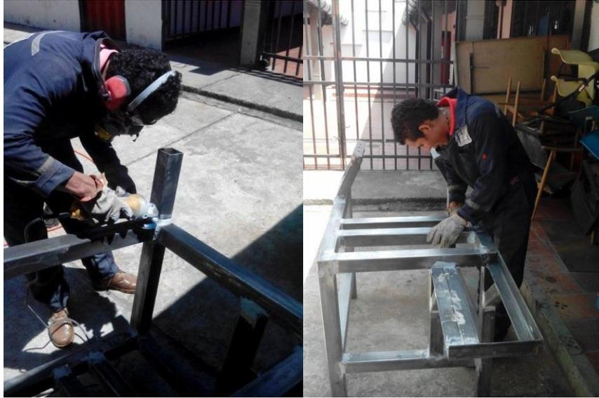
*Figura 34.* Pulido de la estructura y Enmasillada de la estructura. Fuente. Autores del proyecto
