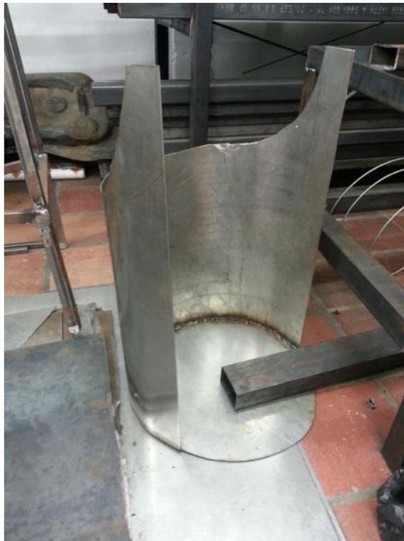
*Figura 31.* Terminación de la cuchara por medio de soldadura. . Fuente. Autores del proyecto
