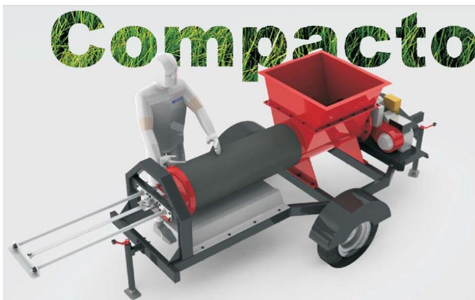
Figura 9. Compactación horizontal con tornillo sin fin. Fuente. (Saenz, 2009)
