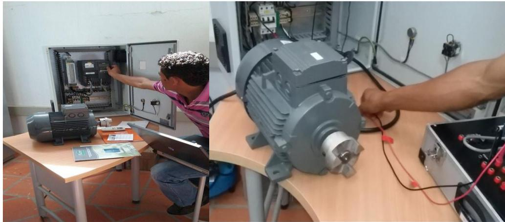
*Figura 45.* Programación del variador de frecuencia. Fuente. Autores del proyecto
