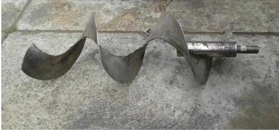
*Figura 35.* Tornillo sin fin construido. Fuente. Autores del proyecto
