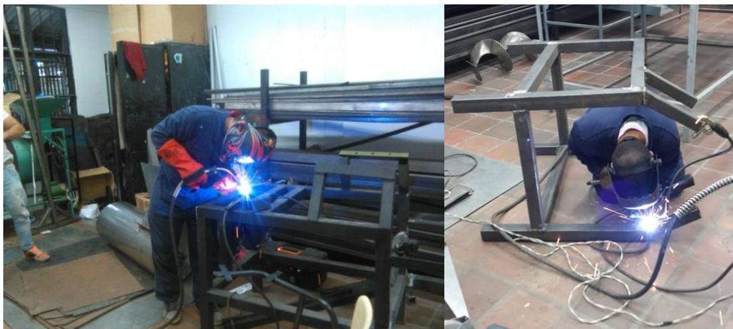
*Figura 33.* Soldadura de la estructura. Autores del proyecto
