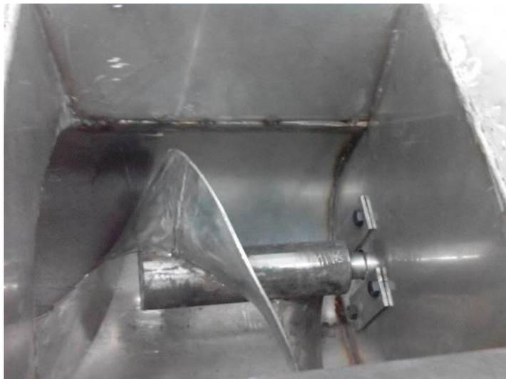
*Figura 36.* Acoplamiento del tornillo sin fin con la unión solidaria de la tolva y cilindro. Fuente. Autores del proyecto
