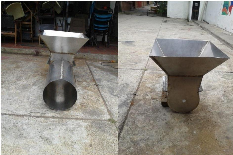
*Figura 30.* Vista frontal y posterior de la unión soldada de la tolva y el cilindro. Fuente. Autores del proyecto
