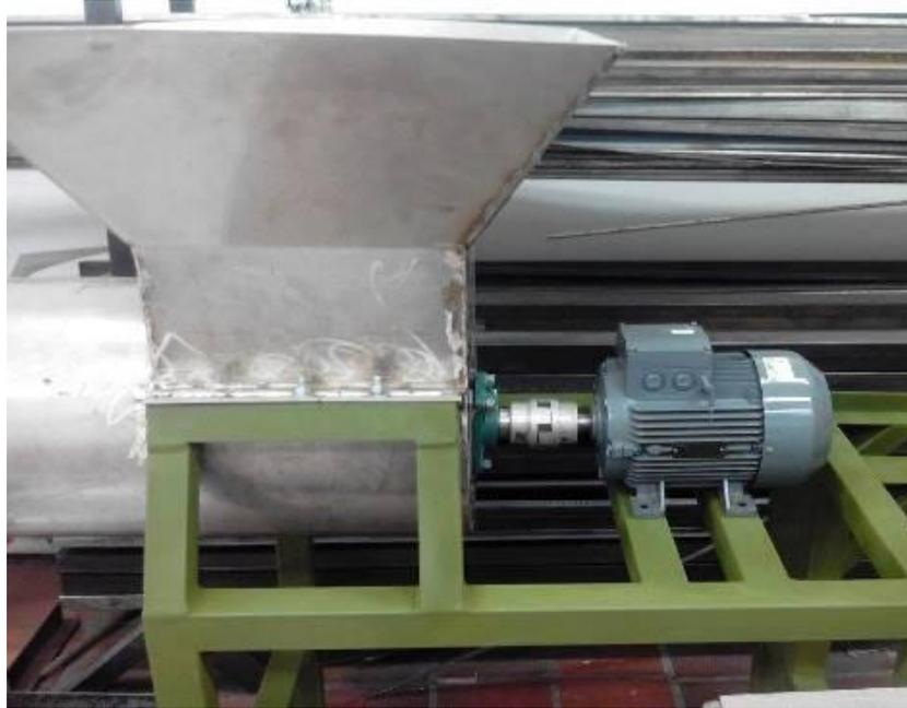
*Figura 37.* Acople del motor con el tornillo sin fin. Fuente. Autores del proyecto
