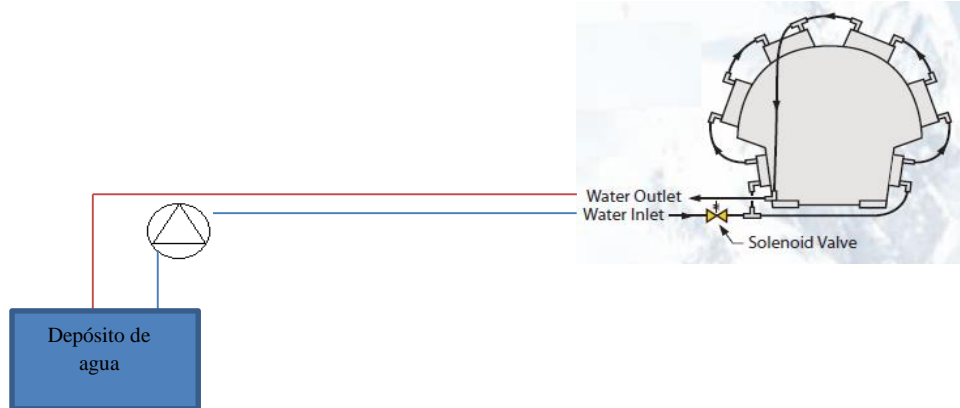
Figura 12. Sistema de enfriamiento de Compresor SABROE
