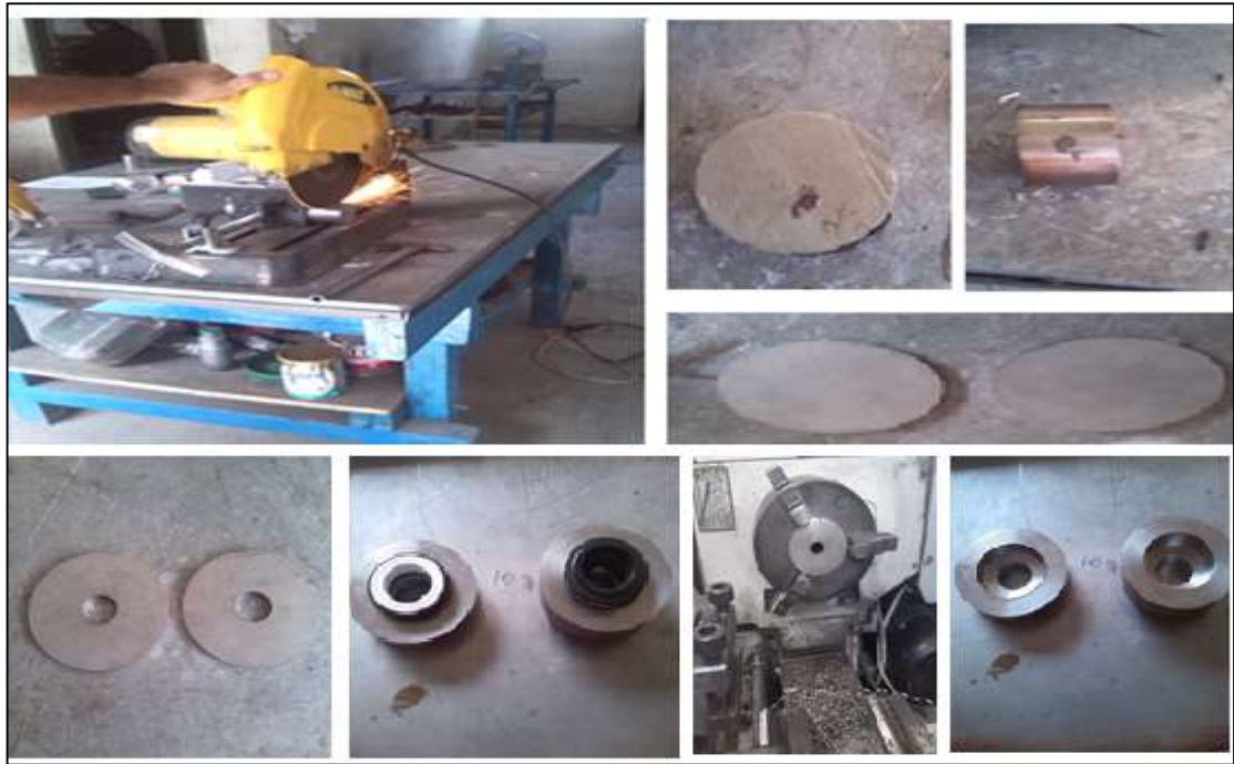
Figura 15. Mecanizado para el sistema de acople
