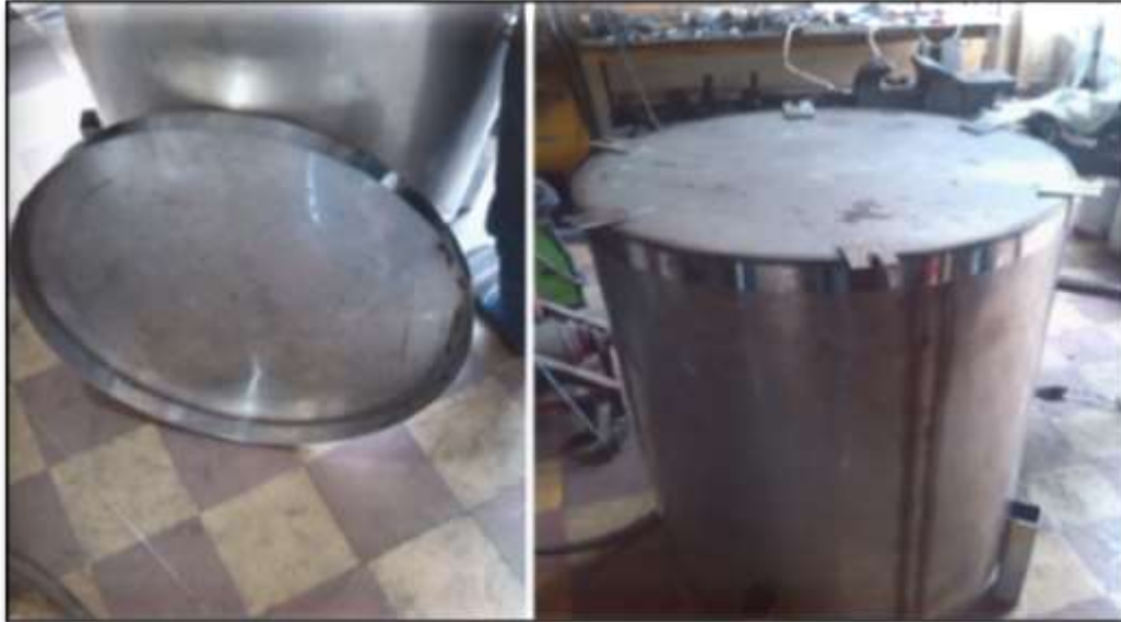
Figura 9. Tapa del tanque y perfiles aseguradores.
