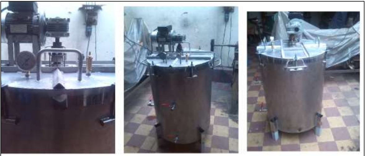
Figura 20. Válvula de seguridad y manómetro
