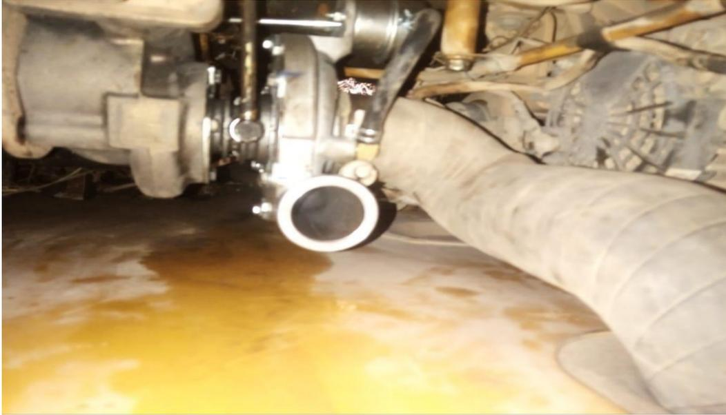
*Nota B4.* Excavadora 313 D. Mantenimiento preventivo, Cambio turbo compresor
