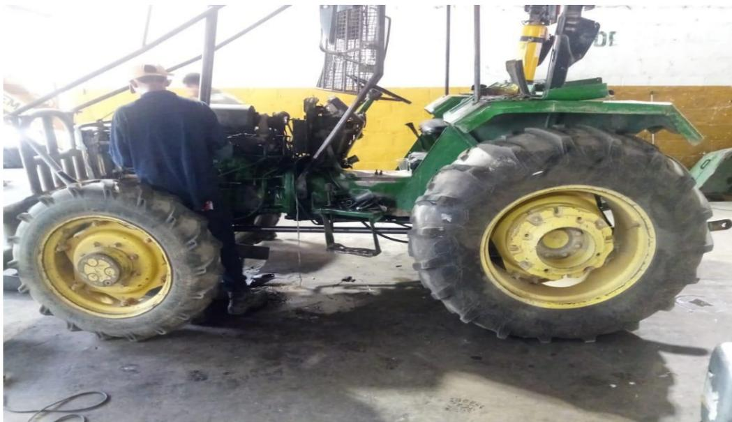
*Nota B5.* Tractor JOHN DEERE 5403 No.3. Mantenimiento preventivo. Sistema hidráulico
