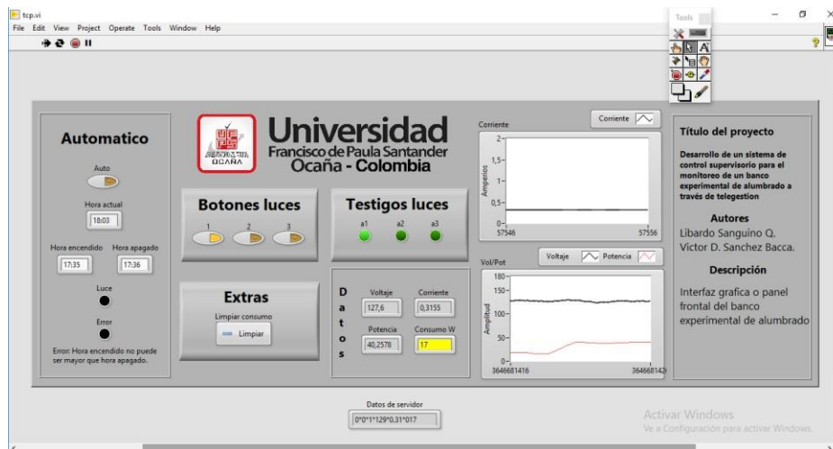
Figura 69. Prueba encendido de lámpara 1 y testigo 1 en el panel frontal Fuente. Autor del proyecto
