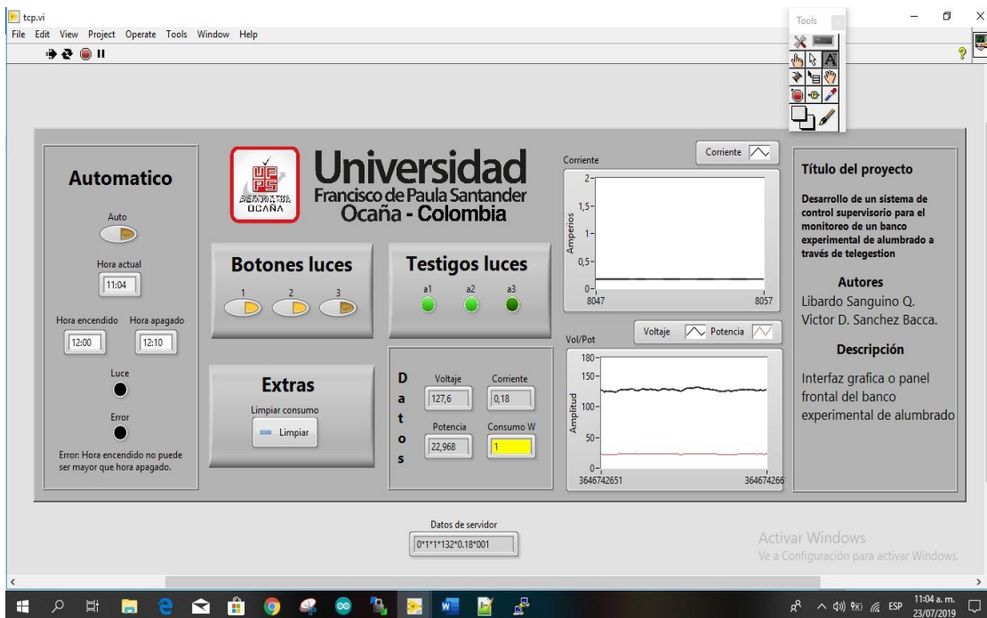
Figura 93. Dato de la corriente en el panel frontal con dos lamparas encendidas Fuente. Autor del proyecto
