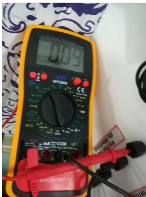
Figura 92. Dato de corriente en multmetro con una lampara encendida Fuente. Autor del proyecto
