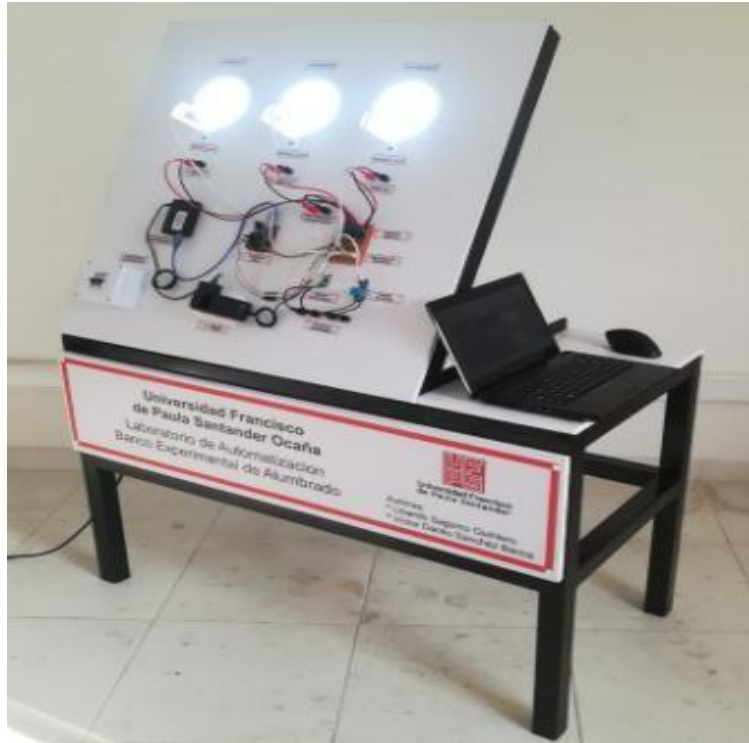
Figura 68. Banco experimental de alumbrado Fuente. Autor del proyecto
