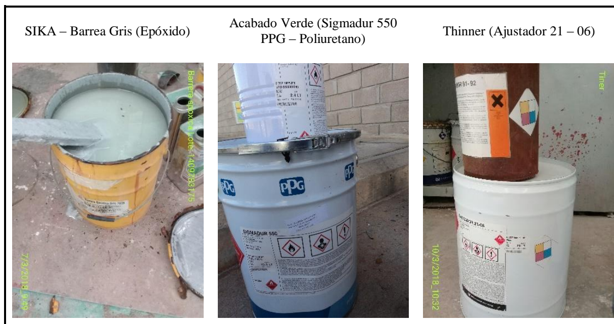
Figura 42. Tipo de pintura con su respectivo Producto. (barrera, acabado y ajustador)
