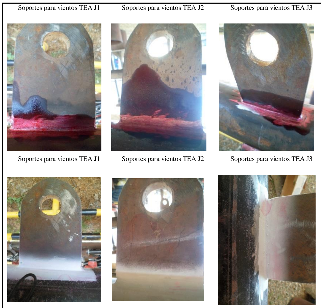
Figura 33. Prueba de Líquidos Penetrantes a los soportes para vientos de las Tea's.
