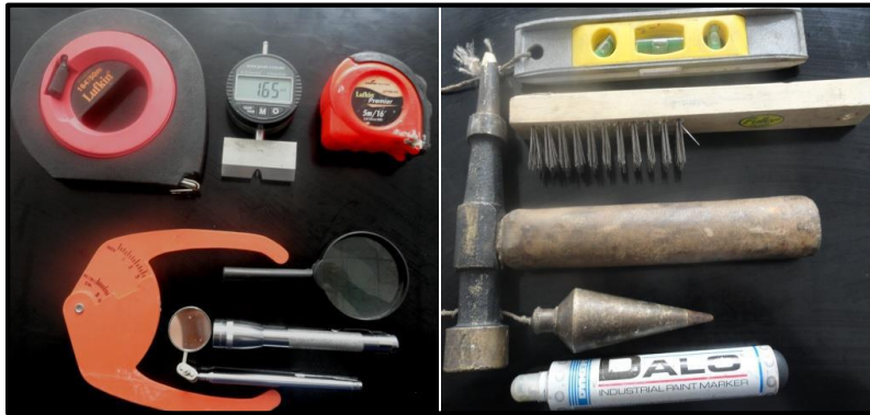
Figura 52. Equipos de inspección visual.
