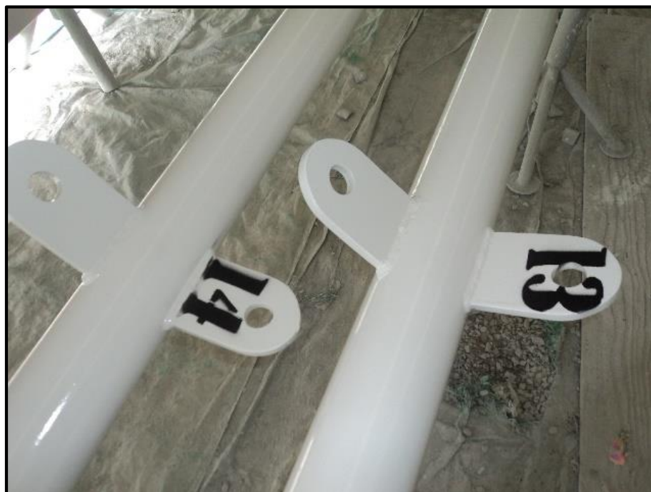
Figura 35. Soportes para vientos de la Tea.
