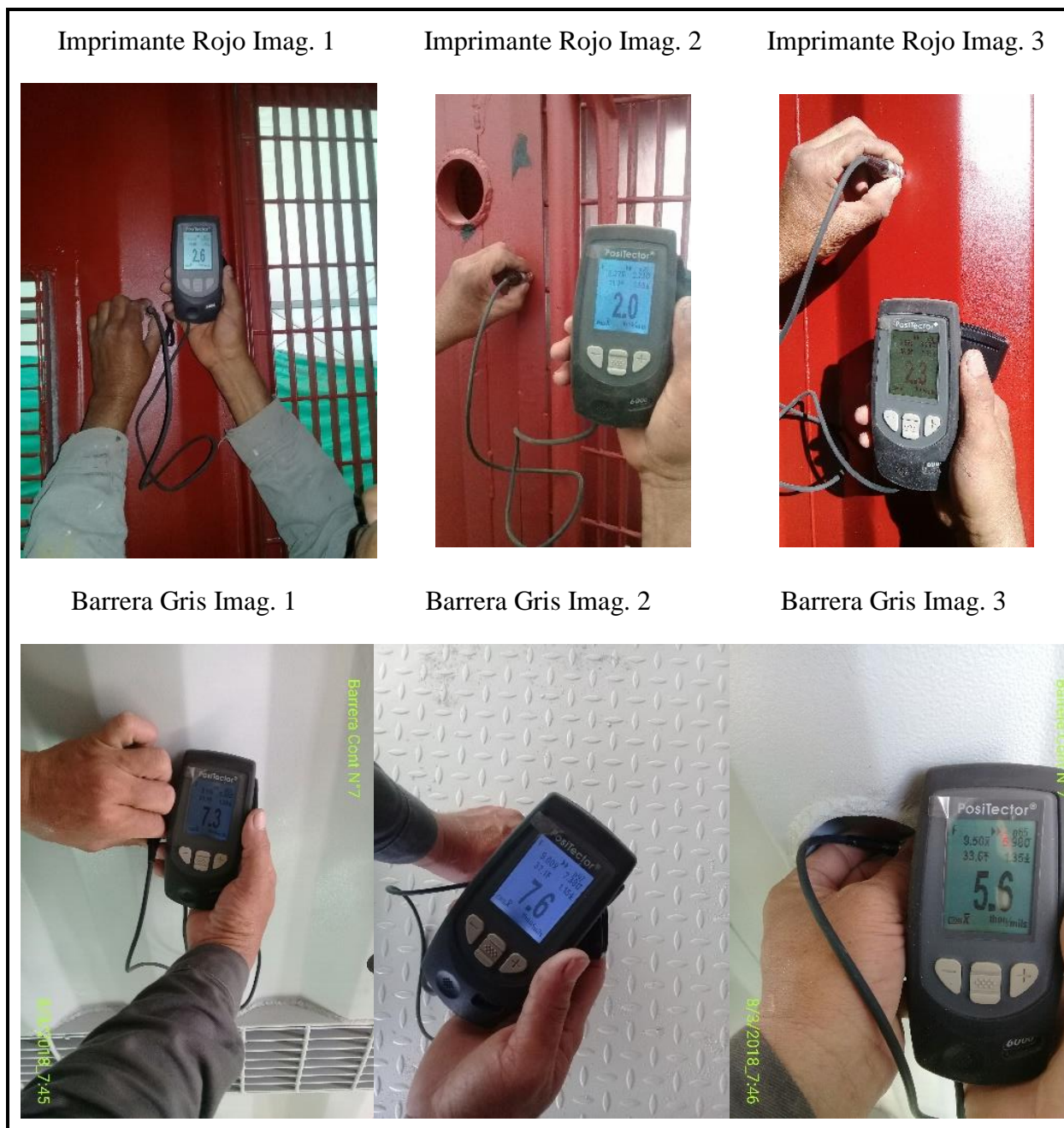
Figura 45. Espesor de pinturas a las facilidades de pozo cbm. (Imprimante)
