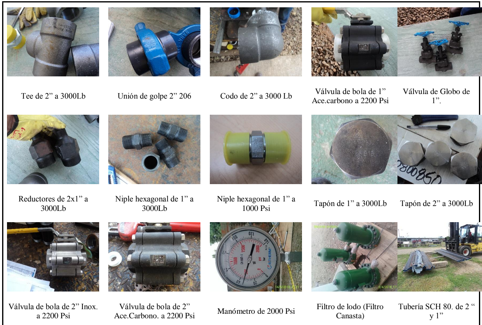
Figura 25. Materiales para la construcción del cabezal de pozo.(segunda parte)
