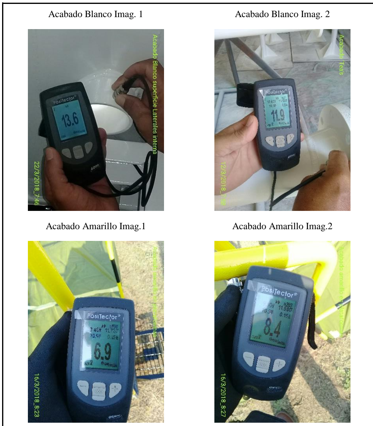
Figura 46. Espesor de pinturas a las facilidades de pozo cbm. (acabados)
