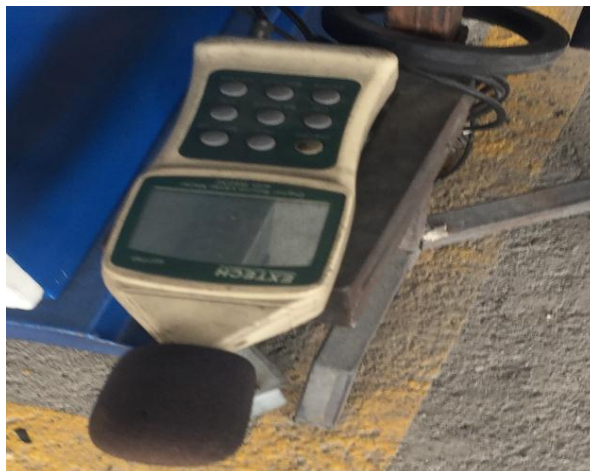
Figura 14. Sonómetro de la pista de motos del CDA el coche, Fotografía tomada por el autor del trabajo de pasantías.
