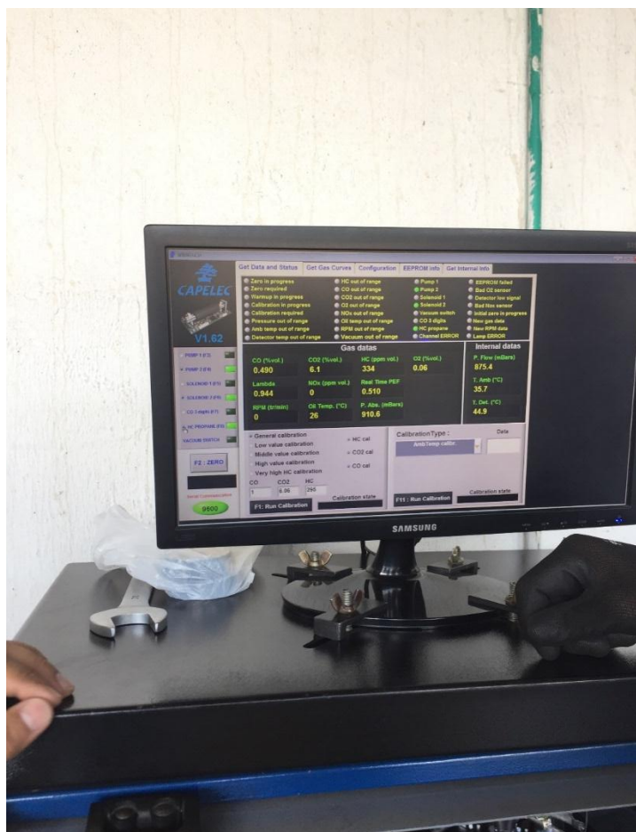
Apéndice C. Imagen que explica como limpiar el analizador de gases del CDA el coche.
