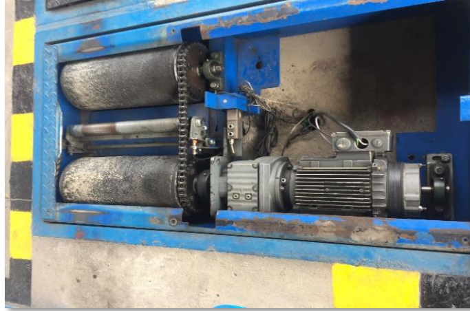
Figura 7. Muestra el banco de suspensión del CDA el coche, Fotografía tomada por el autor del trabajo de pasantías.
