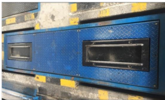
Figura 3. Banco de suspensión del CDA, fotografía tomada por el autor del trabajo de pasantías.
