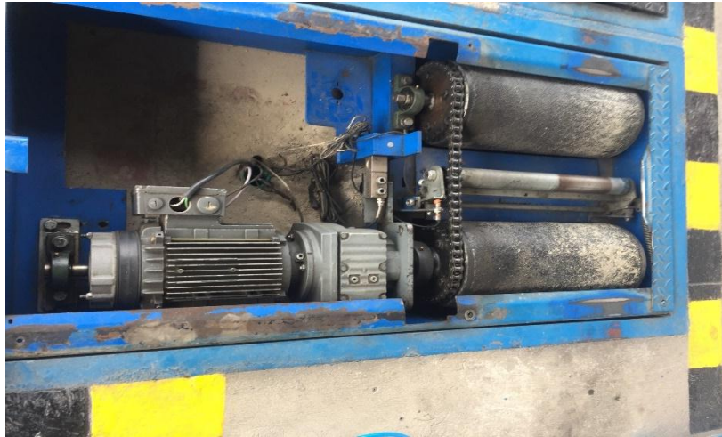
Figura 13. Frenómetro de la pista de motos del CDA el coche, fotografía tomada por el autor del trabajo de pasantías.
