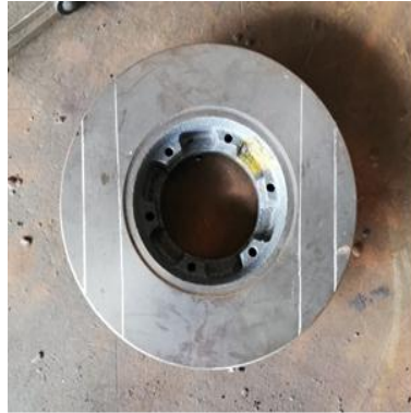
Figura 22. Disco de freno (material base). Fuente. Autor 2019.
