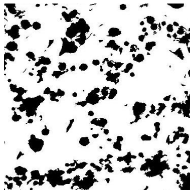
Figura 44. Microestructura de la fundición nodular modificada en ImageJ. Fuente. Autor 2019.
