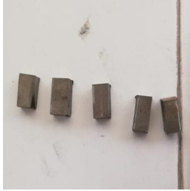
Figura 29. Probetas obtenidas del disco de freno. Fuente. Autor 2019.
