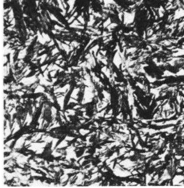
Figura 14. Acero para herramientas AISI H13 (0,9 % C, 1 %, 1 % Mn, 0,50 % Cr, 0,50 % W austenizado a 980° C, templado en aceite y revenido a 218° C). Fuente. (Va Larre, 2000).
