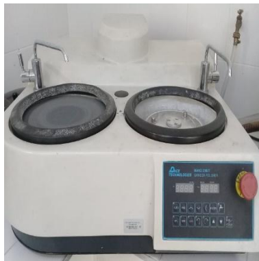
Figura 36. Maquina para pulir probetas Nano 2000T. Fuente. Autor 2019.
