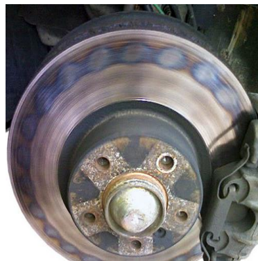
Figura 1. Falla por sobrecalentamiento el disco de freno. Fuente. (Kashima University, 2013).
