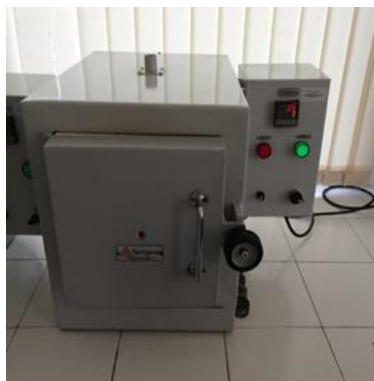
Figura 23. Horno Terrigeno utilizado para realizar los tratamientos térmicos. Fuente. Autor 2019.
