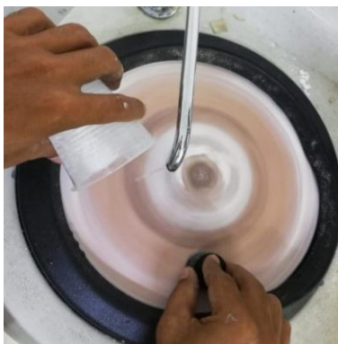
Figura 37. Pulido final con alúmina. Fuente. Autor 2019.
