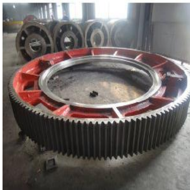
Figura 21. Engranaje de fundición nodular. Fuente. (Luoyang Evon Engineering, 2016)
