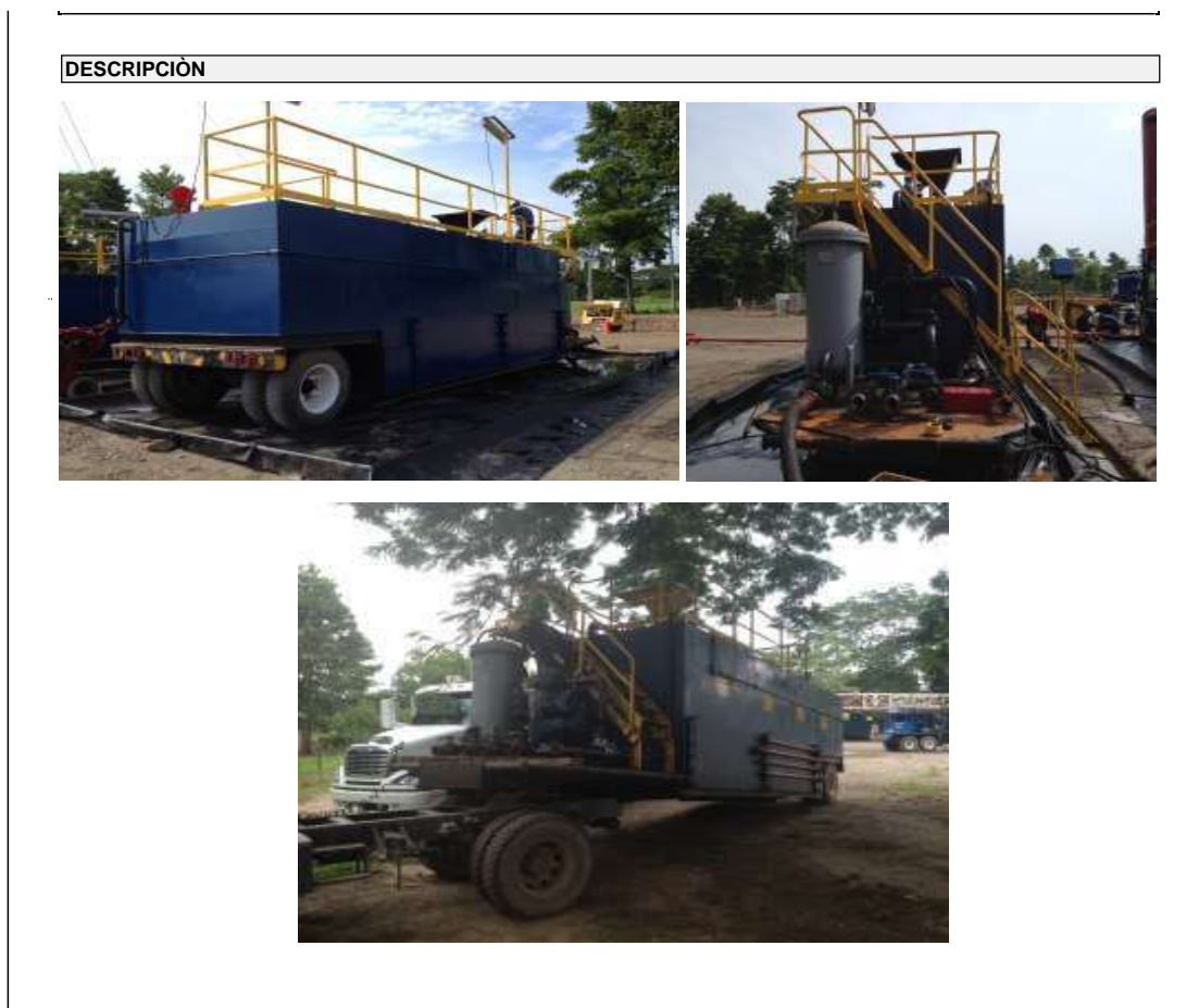
Figura 13 Ficha técnica del tanque de lodos rig # 1
