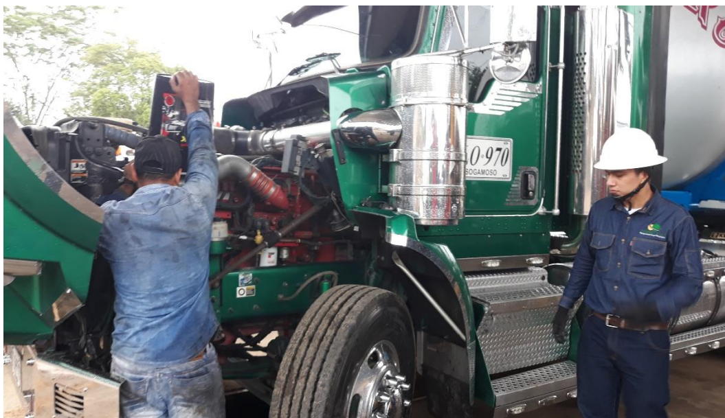
Figura 42. Inspección y cambio de aceite T10-TLO970
