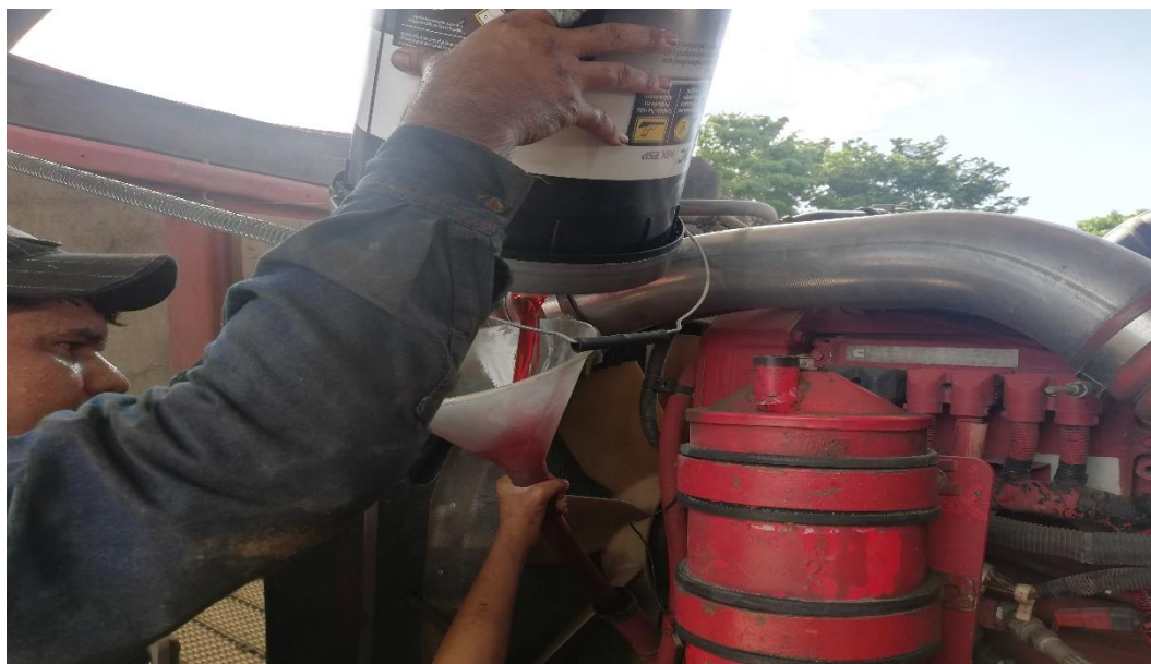
Figura 48. Cambio de aceite y filtros T10-SSY530
