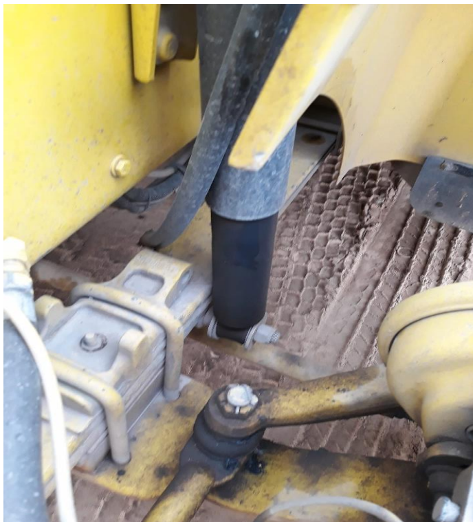
Figura 18. Fuga de amortiguador izquierdo tractocamión SZK-715.
