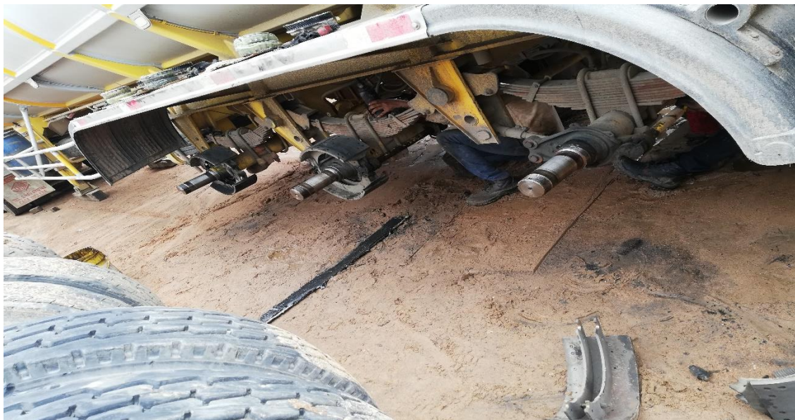
Figura 49. Engrase y ajuste de muelles T10-SXS378
