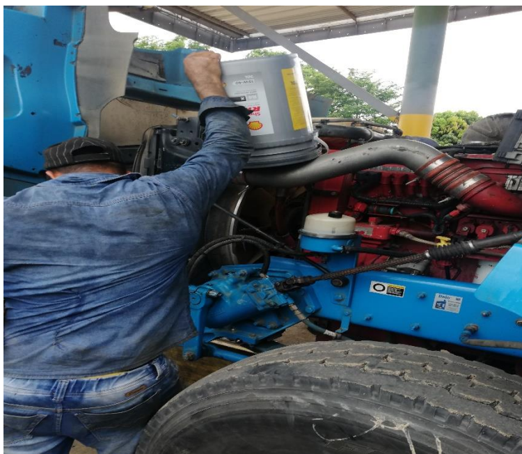
Figura 50. Cambio de aceite y filtros T10-SZY817
