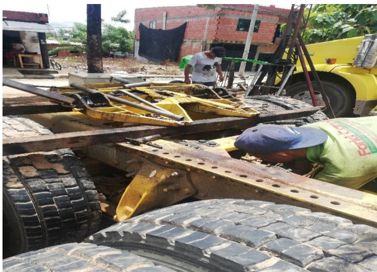
Figura 51. Mantenimiento quinta rueda T10-WCS937
