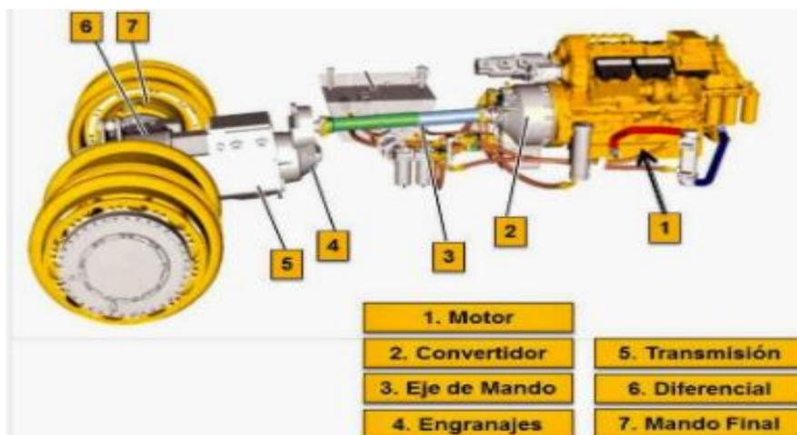
*Figura 7. Tren De Potencia. (SIS Caterpillar, 2020)*
