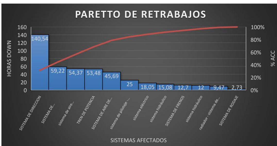
**Figura 10. Diagrama De Pareto Sistemas Afectados Vs Horas Down. (Autor del proyecto)**
