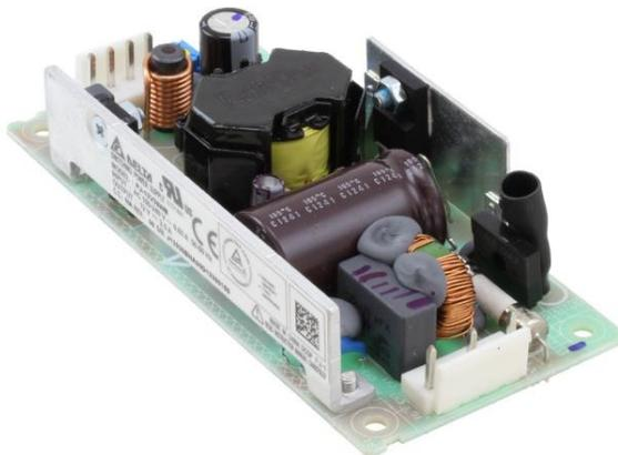
Figura 29. Fuente alimentación. (Electronics, 2019)
