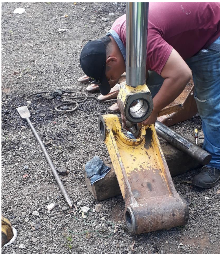
Figura 16. Cambio de empaque cucharon de EX-KO-210-1-P. Pasante. (2019)
