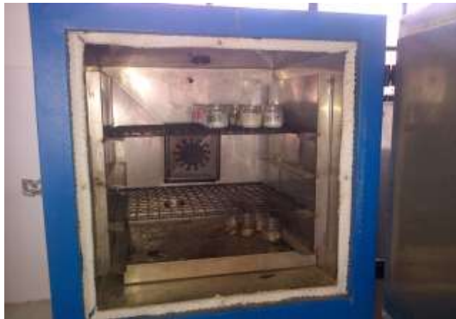
Figura 11. Muestras de cuarzo en el horno para el secado
