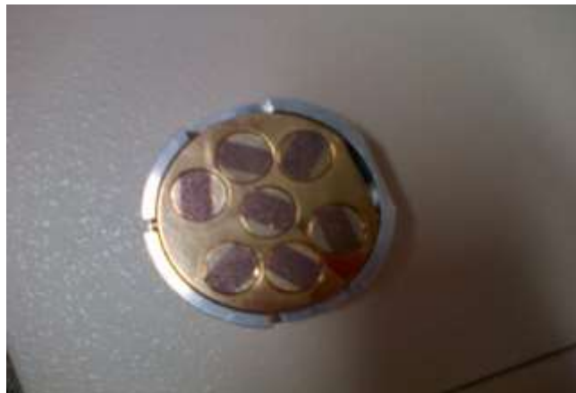
Figura 25. Muestra recubierta en oro para el análisis en el microscopio electrónico de barrido
