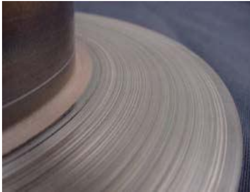
Figura 12. Falla de disco por ralladuras y surcos.
