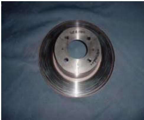
Figura 13. Falla por depósitos de material en los discos.
