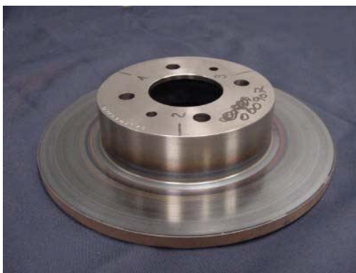
Figura 7. Falla de disco por temperatura excesiva.
