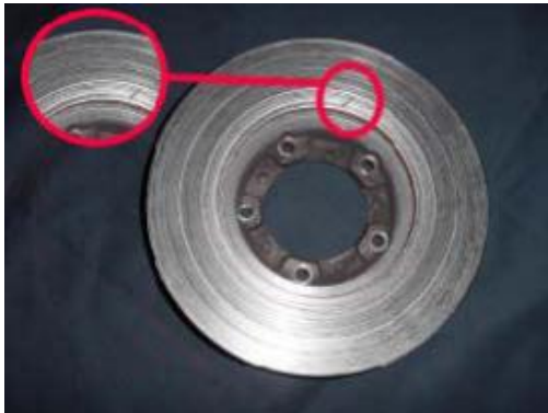
Figura 6. Falla por holgura en los rodamientos.
