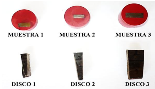
Figura 46. Muestras atacadas con Nital al 2%.
