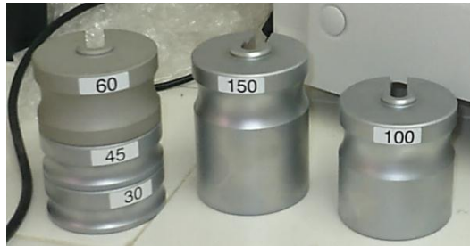
Figura 39. Cargas para los diferentes tipos de dureza Rockwell.
