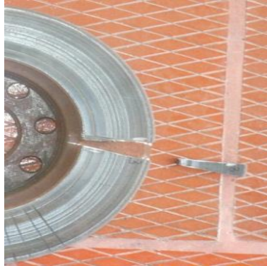
Figura 42. Extracción de la probeta para el análisis metalográfico.
