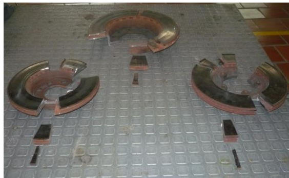
Figura 50. Extracción de las probetas de compresión.
