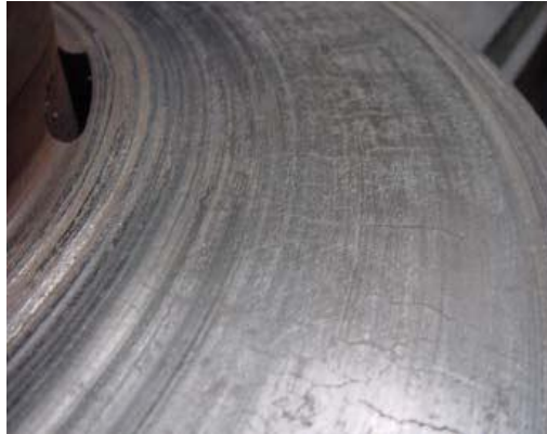
Figura 8. Falla por desgaste excesivo del disco.
