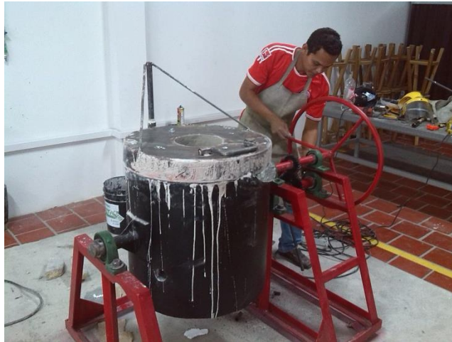
Foto 8. Montaje de la tapa fija móvil en el cilindro
