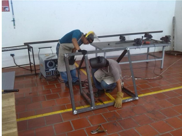
Foto 3. Construcción de la bancada del horno
