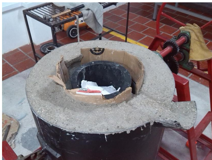
Foto 7. Montaje del crisol
